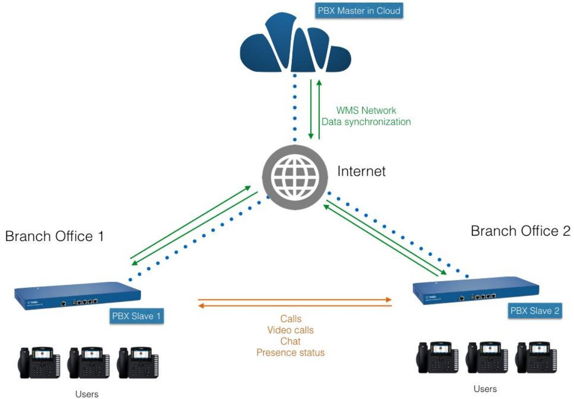
Bei **Verbindungsproblemen** gewährleistet die Slave-Anlage die Service-Verfügbarkeit für alle Nutzer einer Niederlassung. Die Anrufe werden dann **über lokale Verbindungen weitergeleitet** (ISDN-Leitungen, analoge Leitungen oder GSM-Netz).
